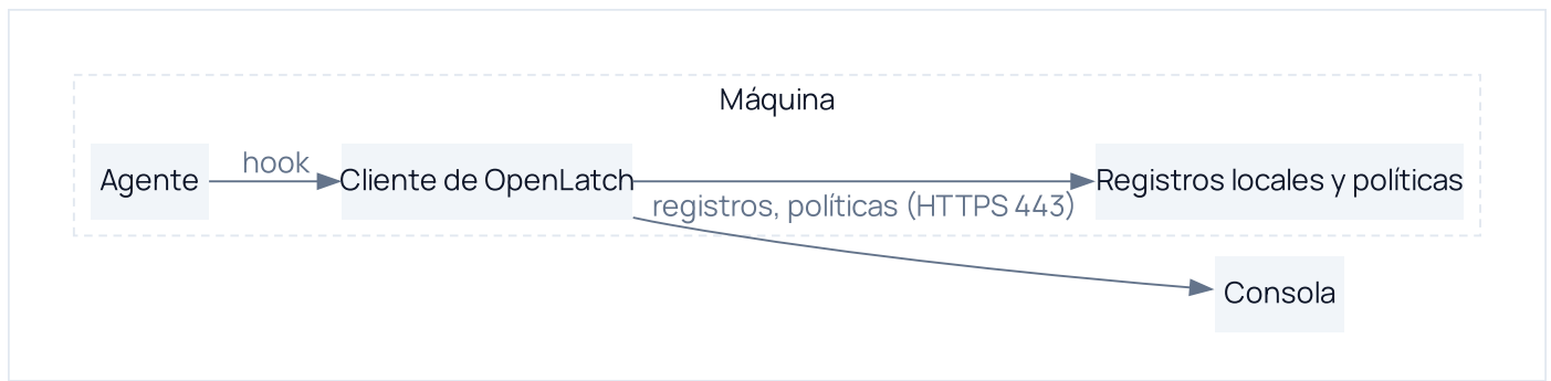
Figura 1. Vista de despliegue: el cliente en cada máquina y la consola como servicio.
