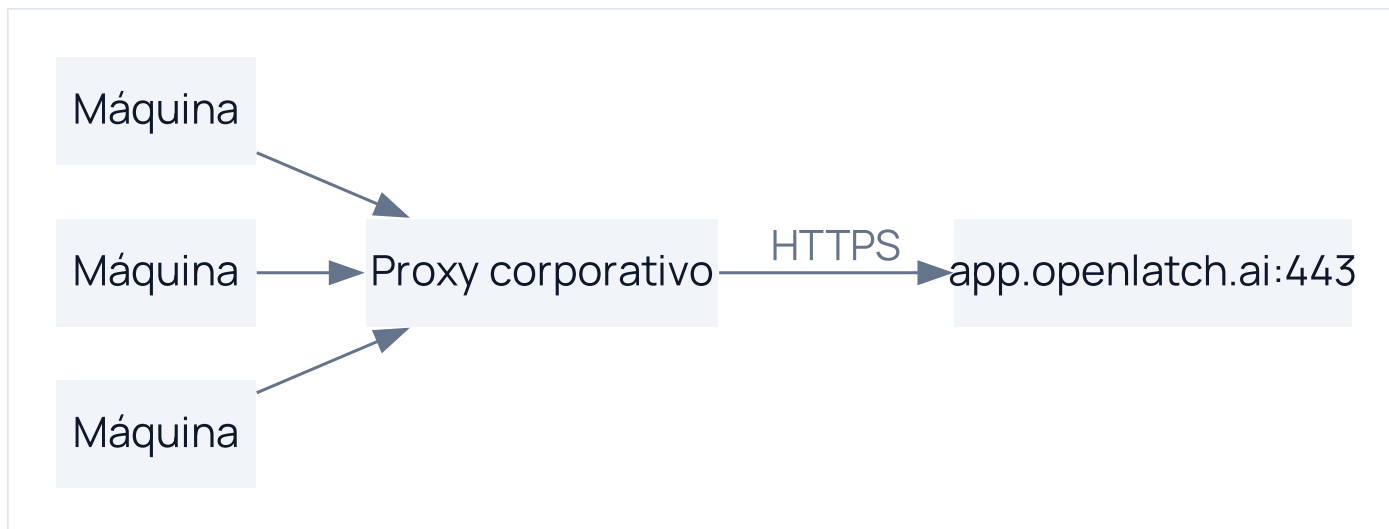
Figura 1. Un parque de máquinas detrás de un proxy corporativo: un único destino saliente, nada de entrada.
